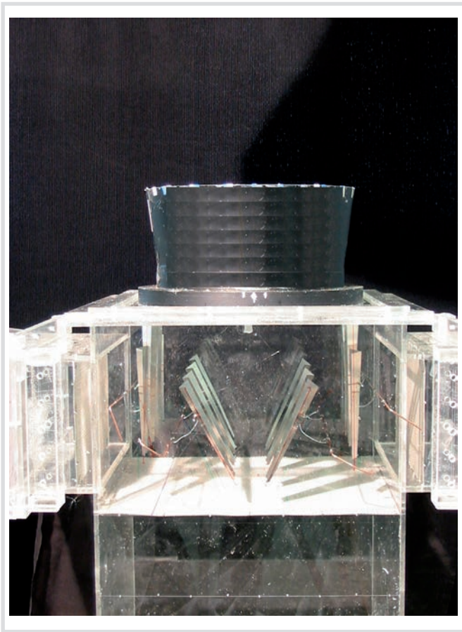
Bild 4. Modell eines Hybrid-Zellenkühlturms mit Leitflächen als Mischeinrichtung.
