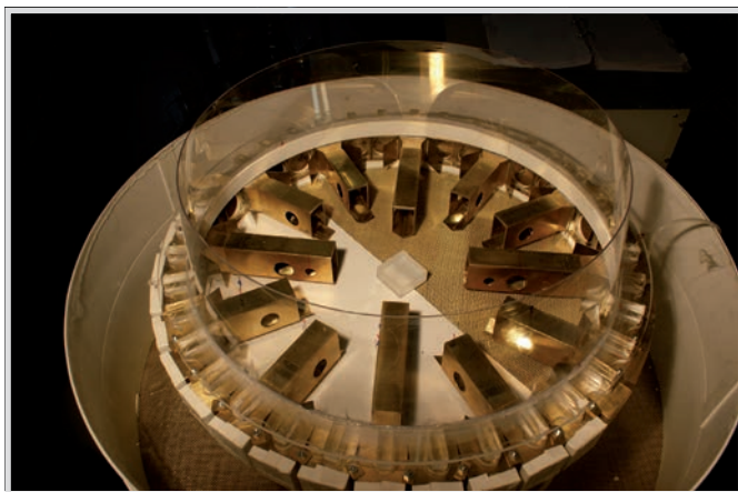
Bild 7. Blick in den Modellkühlturm mit den Mischungs-einrichtungen.
